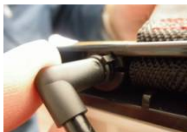
バッテリーの排気口にガス抜き用L形プラグホースを挿入する
