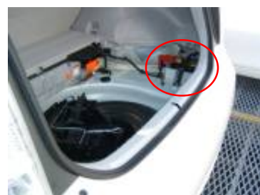
写真の車両:プリウス30系 ラゲージルーム内の右側にバッテリーが搭載
